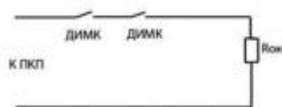
Схема подключения инерционного магнитоcontactного датчика ДИМК
