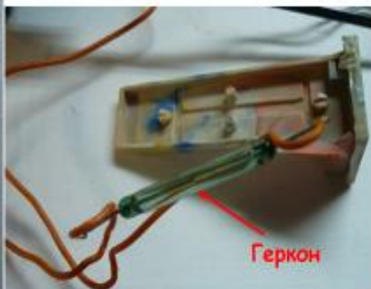
Схема подключения инерционного магнитоcontactного датчика ДИМК
