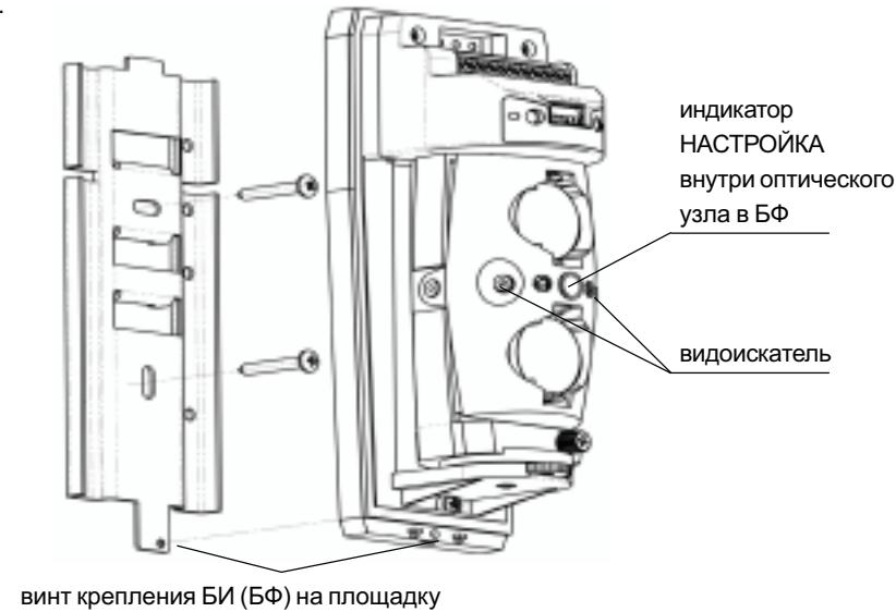
Закрепить площадку на трубе при помощи хомута и двух винтов M4x35.
