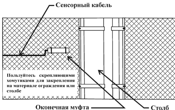
Рисунок 6 - Вариант крепления оконечной муфты
