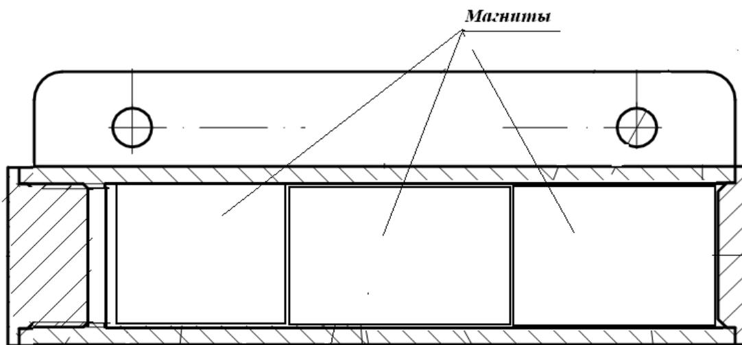
б) Конструкция блока магнитов
