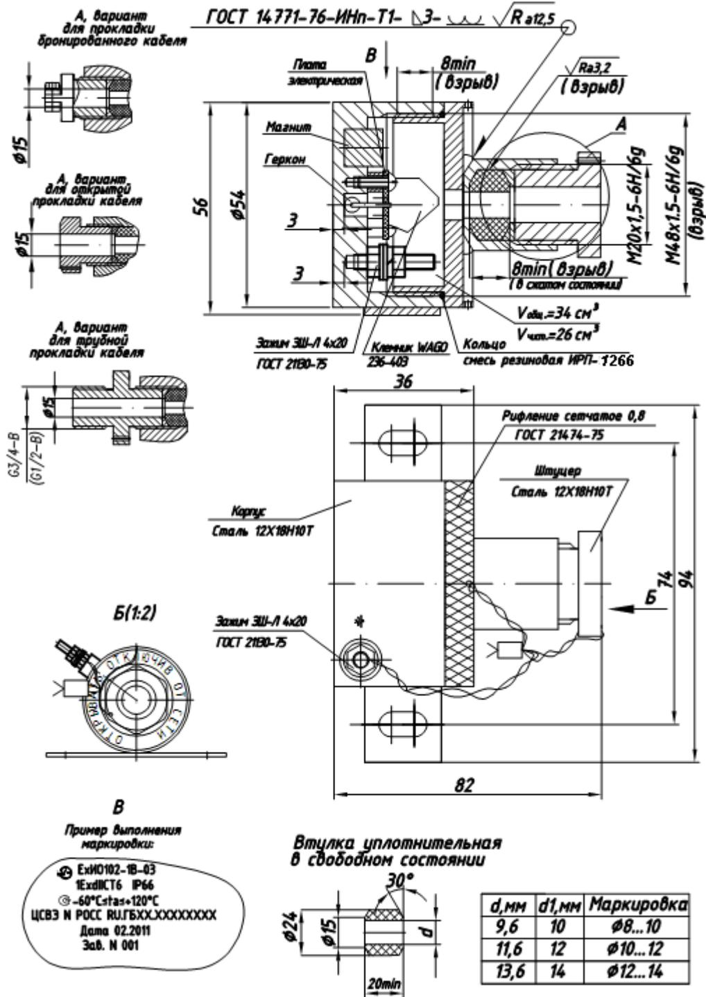
Рисунок А2 Габаритный чертёж Извещателей моделей 03 с элементами взрывозащиты
