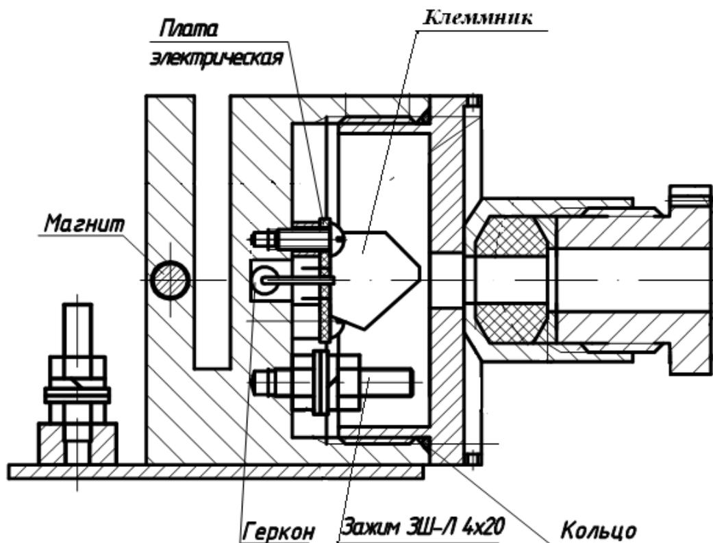
Рисунок 3 . Конструкция Извещателей модели 04
