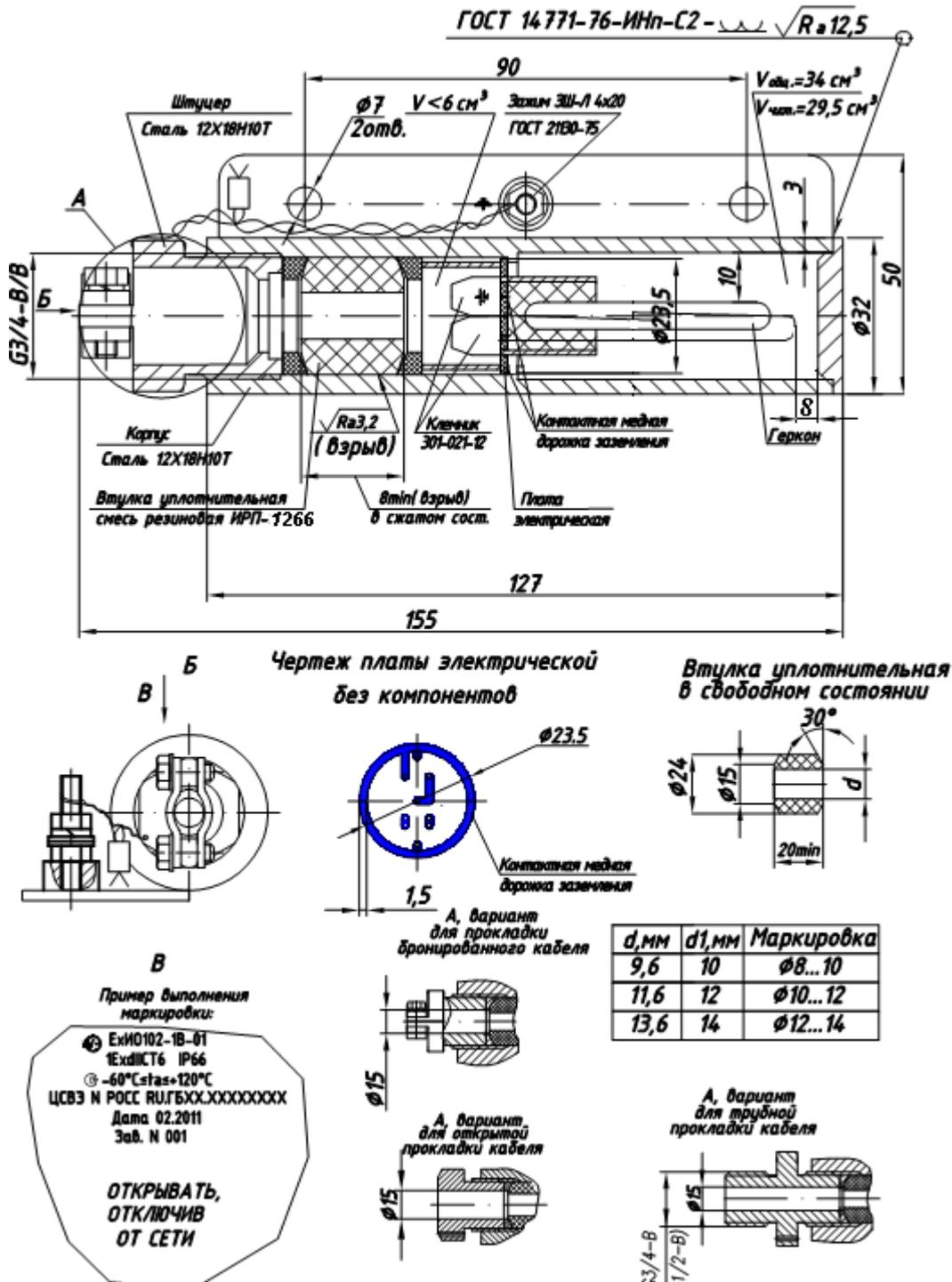
Рис. А.1 Габаритный чертёж Извещателей моделей 01,02с элементами взрывозащиты
