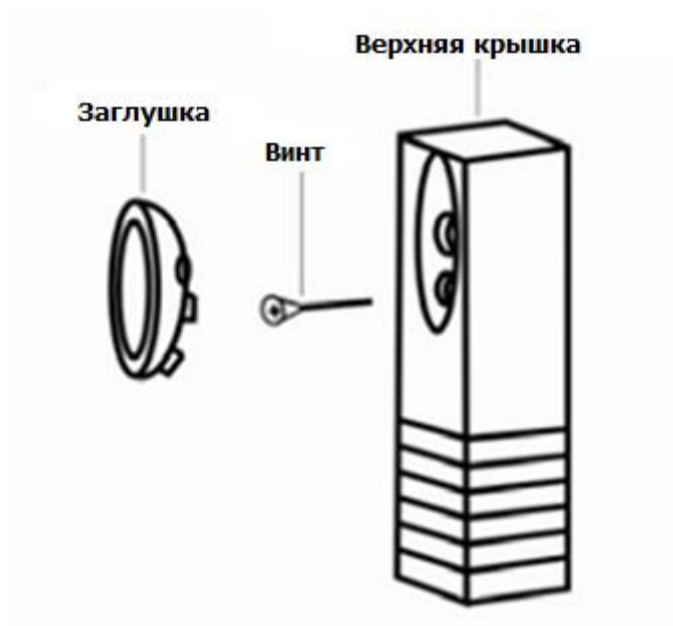
Рисунок 2 – Открытие корпуса извещателя
