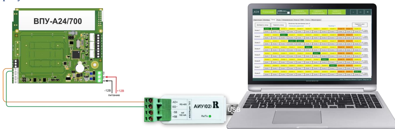
Рис. 18. Схема подключения для конфигурирования ВПУ-A24/700(О)
