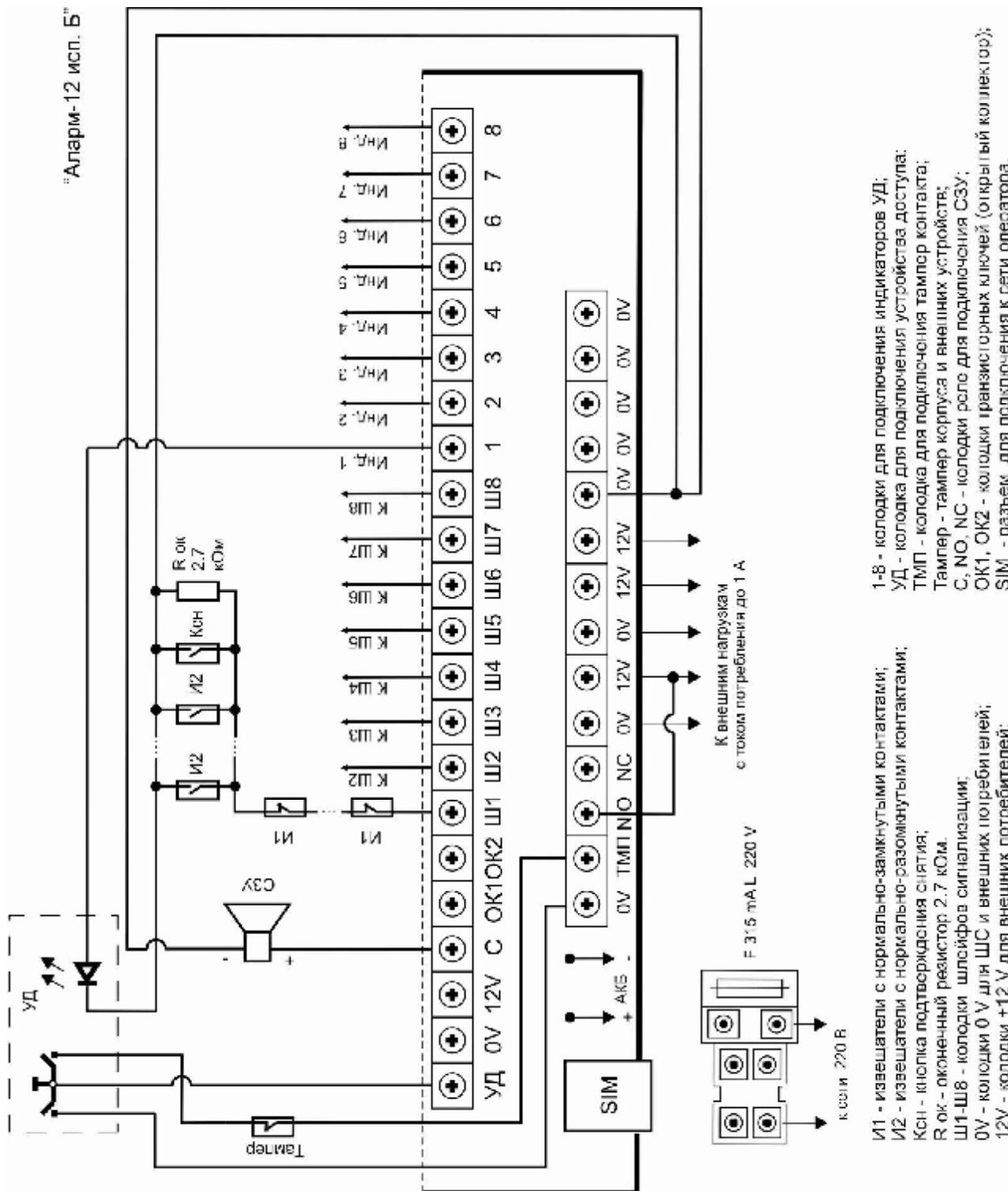
Рисунок 2. Схема подключения прибора исполнения «Б»
