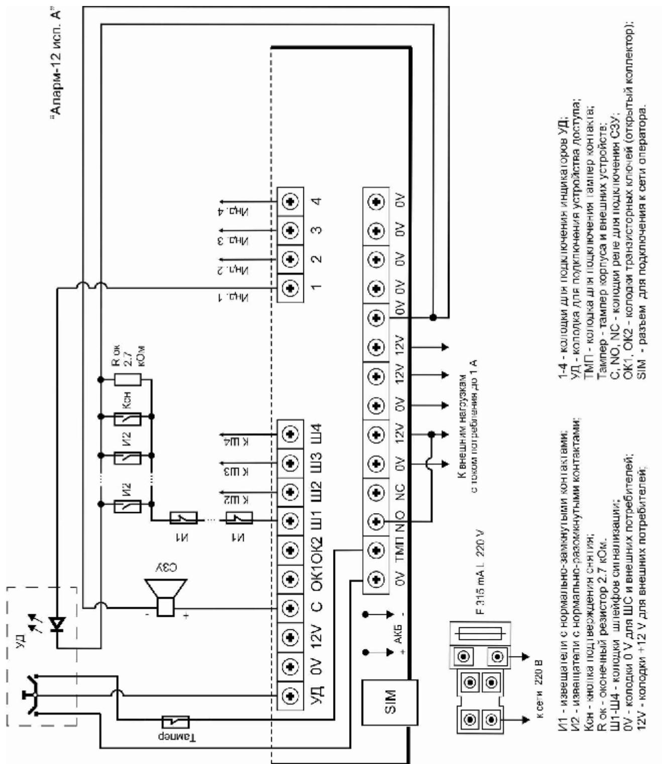
Рисунок 1. Схема подключения прибора исполнения «А»
