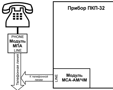
Рисунок 7 - Подключение прибора к телефонному аппарату с применением модуля МПА
